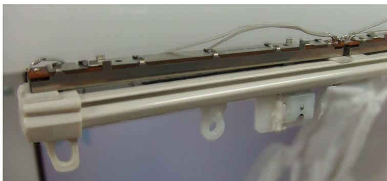
図 6.5: カーテンセンサ: カーテンレールにスライダセンサを組み込んでいる
